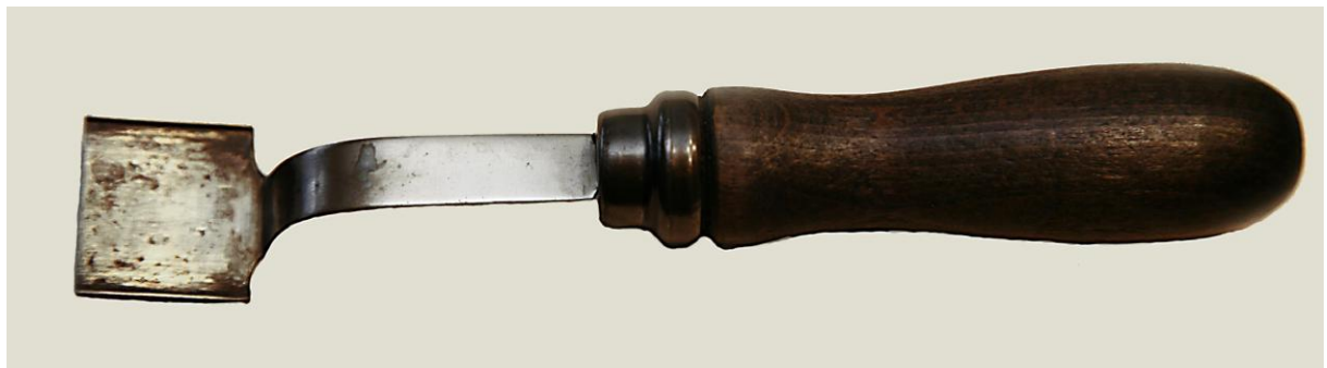
Glühschaufel zur Herstellung von Diatomeenglühppräparaten
