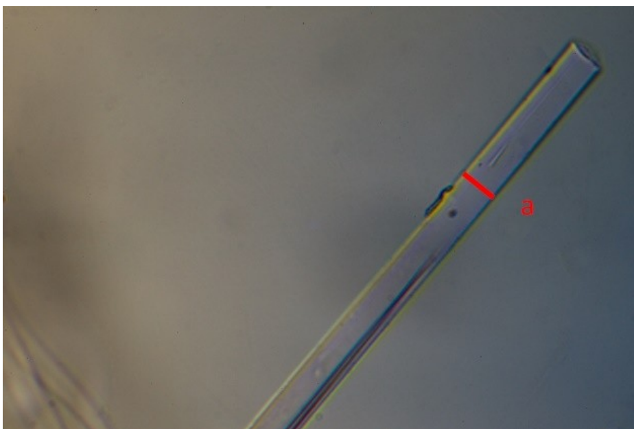
Bild 8: Glasfaser im „streifenfreien Feld“
