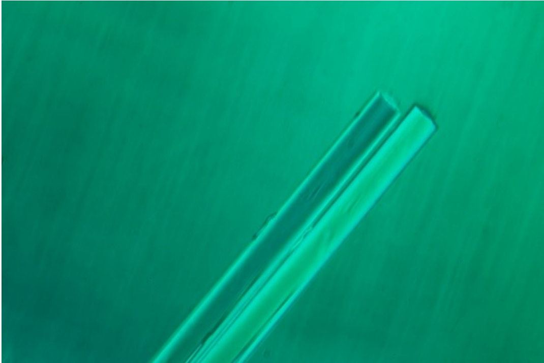
Bild 11: Glasfaser mit Bildaufspaltung
