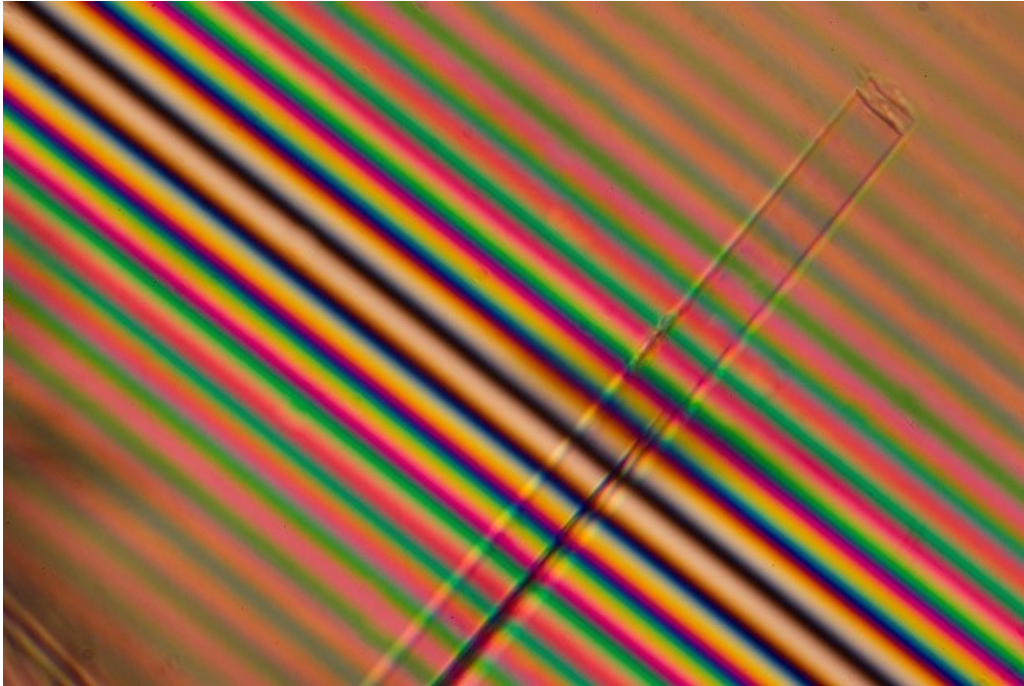
Bild 10: Glasfaser mit engen Interferenzstreifen
