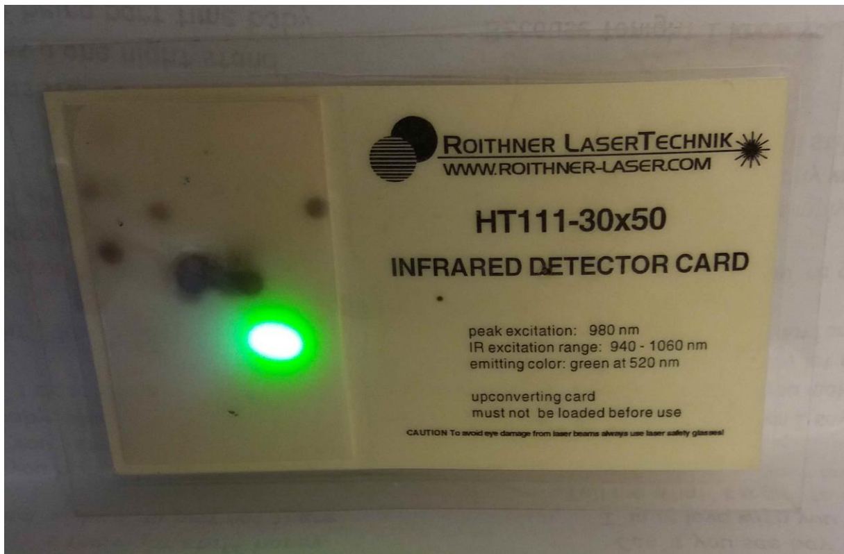
Bild 3: Infrarot-Detektorkarte: intensiver grüner Fleck durch hohe Leuchtstoffdichte
